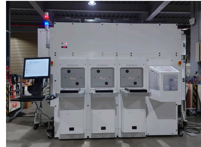
① ② : Wafer plasma etching
